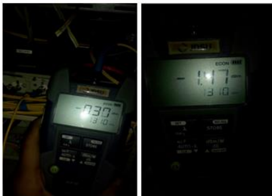
Gambar 21. Hasil pengukuran redaman fiber optic di kedua provider
