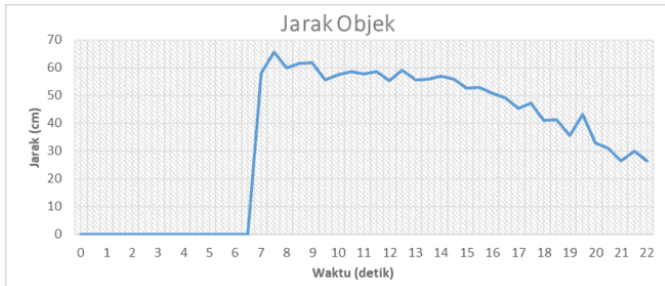
Gambar 17. Pengukuran deteksi jarak objek dinamis mendekat
