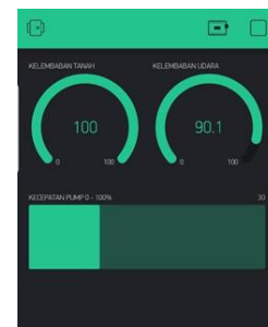
Gambar 5. Tampilan Blynk Input DHT 22, Fc 28 dan Output Kecepatan Pompa
