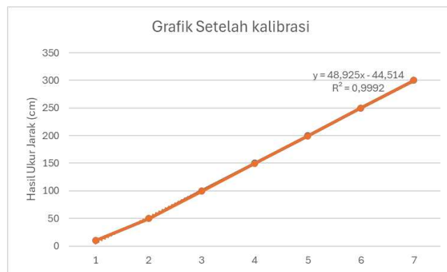
Gambar 6. Grafik Perbandingan Sensor Ultrasonic JSN-SR04T dengan meteran setelah kalibrasi
