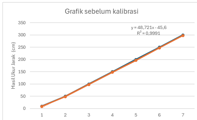
Gambar 5. Grafik perbandingan hasil uji sensor JSN-SR04T dengan meteran sebelum kalibrasi
