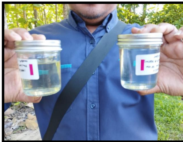
Gambar 17. Warna Fisik Oli Sebelum dan Sesudah Dilakukan Purifikasi
