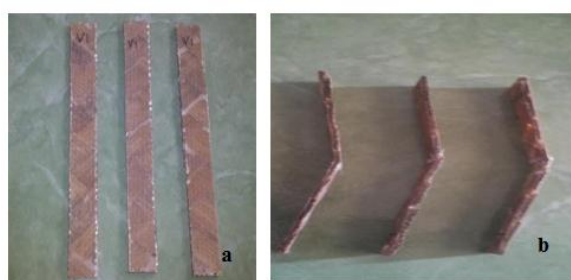
Gambar 6. (a) Spesimen awal variasi 1 dan (b) Spesimen setelah uji bending.
