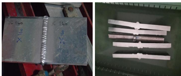
Gambar 5. Hasil pengelasan dan hasil pemotongan
