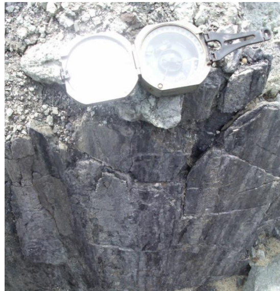
Gambar 9. Kenampakan cermin sesar dengan kemiringan 80°-90° ke arah barat laut, difoto ke arah tenggara
