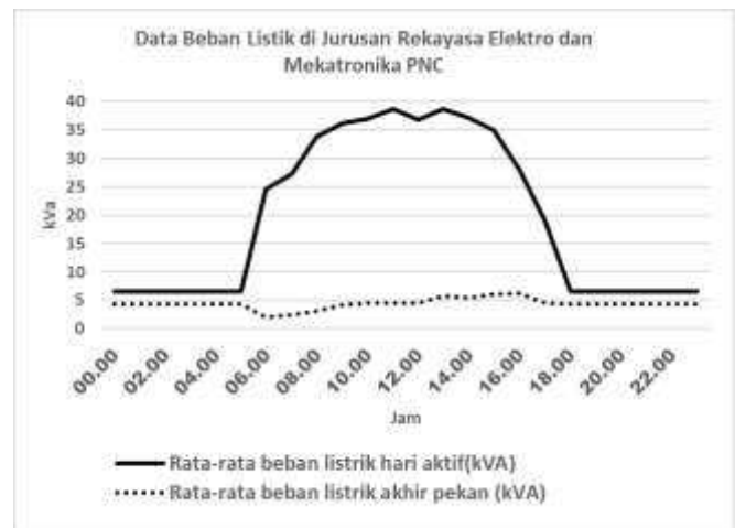
Gambar 5. Data Beban Listrik di Gedung Jurusan Rekayasa Elektro dan Mekatronika
