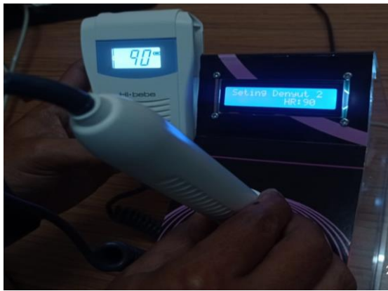
Gambar 5. Pengujian simulator dengan setting 90 BPM
