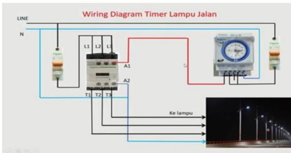
Gambar 1. Blok Diagram Kontrol Pewaktu menggunakan Timer Theben pada PJU [5]
