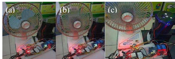
Gambar 10. Pengujian Respon Aktuator pada Kondisi Kualitas Udara: (a) Baik, (b) Sedang, (c) Buruk
