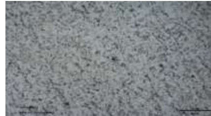
Struktur Mikro 500x daerah Weld Metal Tanpa PWHT
