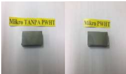
Gambar 5. Spesimen Uji Struktur mikro setelah di etsa
