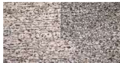
Sruktur Mikro 100x daerah Base Metal PWHT
