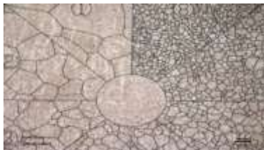
Struktur Mikro 100x daerah Weld Metal PWHT
