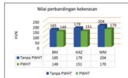
Gambar 23. Diagram hasil perbandingan uji kekerasan
