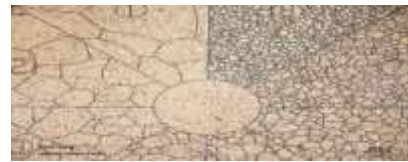
Struktur Mikro 100x daerah Weld Metal Tanpa PWHT
