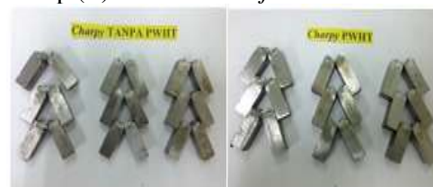
Gambar 20. Spesimen hasil uji Impact metode charpy
