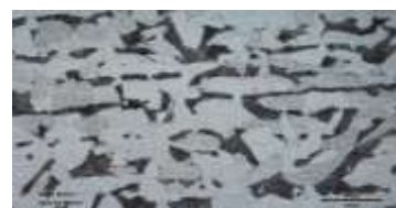
Struktur Mikro 500x daerah Base Metal PWH
