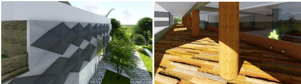
Gambar 9 Cladding metal dan cladding kayu
