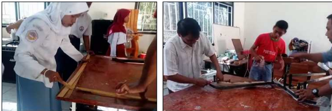
Gambar 2. Mengoles Lem dan Mem-bending Bambu Pada Cetakan (Sumber: Tim PkM Maospati, 2024)
