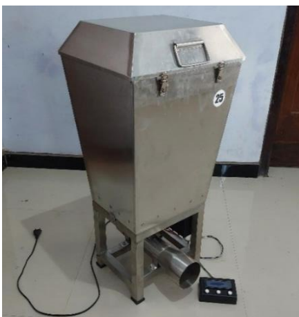
Gambar 1 Sistem mekanik alat pemberi pakan ikan otomatis
