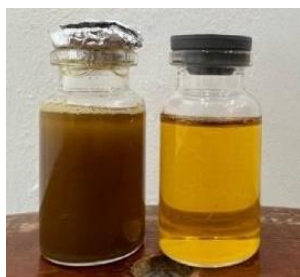
Gambar 1: Minyak prepupa BSF sebelum (kiri) dan sesudah penjernihan (kanan)
