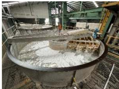
Gambar 9. Kondisi mesin krofta sebelum dibersihkan
