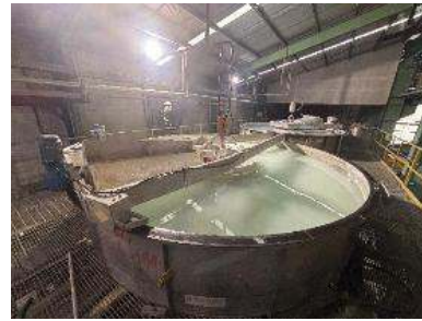
Gambar 10. Kondisi mesin krofta setelah dibersihkan
