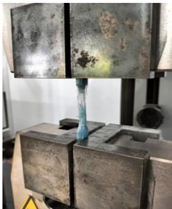
Gambar 4. Proses Uji Tarik Menggunakan Mesin UTM
