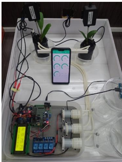
Gambar 5. Alat IoT untuk monitoring pembibitan tanaman
