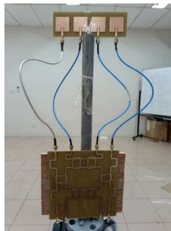
Gambar 12. Butler Matrix 4X4 dan Antena Array
