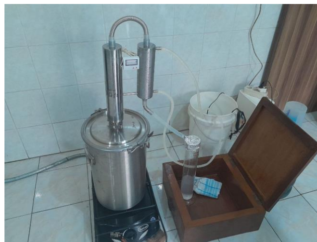
Gambar 1. Alat dan Proses Penyulingan Minyak Daun Sirih Hijau
