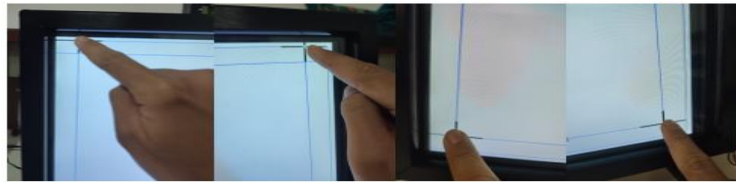
Gambar 8. Kalibrasi sistem menggunakan human interface device (HID)
