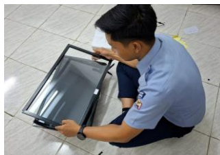
Gambar 6. Pemasangan touch frame pada layar bagian depan televisi
