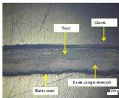
Gambar 14 Kerapatan serat perendaman air laut 2 minggu
