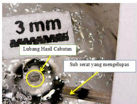
Gambar 11 Hasil uji pull out serat perendaman air laut 4 minggu
