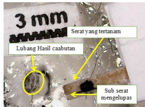
Gambar 10 Hasil uji pull out serat perendaman air laut 3 minggu
