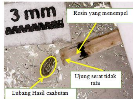
Gambar 9 Hasil uji pull out serat perendaman air laut 2 minggu
