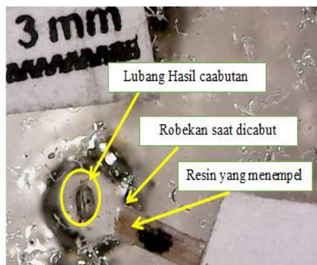
Gambar 8. Hasil uji pull out serat pandan duri perendaman 1 minggu
