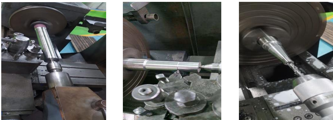
Gambar 4. Beberapa proses bubut spindle test bar
