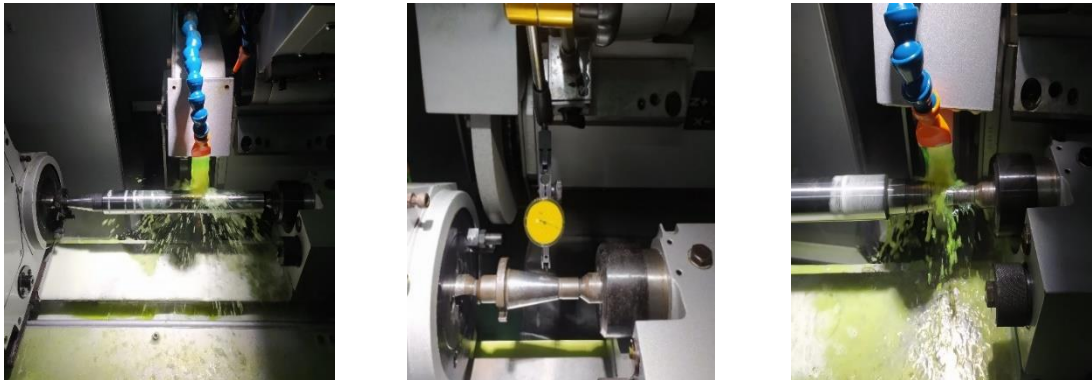
Gambar 5. Proses Penggerindaan Spindle Test Bar
