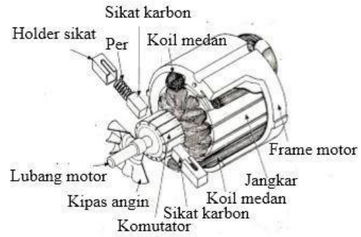
Gambar 2. Konstruksi Motor Universal
