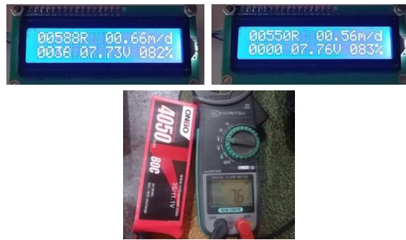
Fig. 10. Data accuracy testing between Arduino and AV meter
