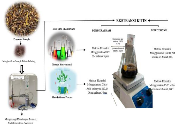
Gambar 1. Skema Ekstraksi Kitin dari Belalang Hijau ( Oxya Chinensis )
