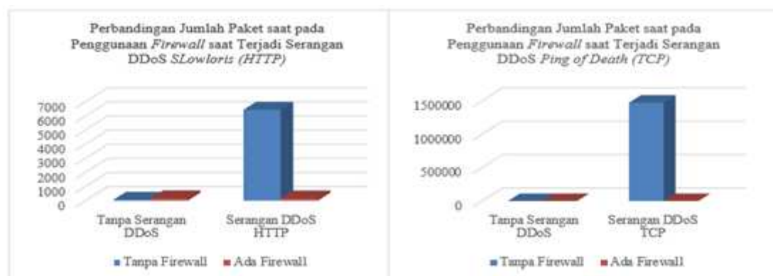
Gambar 24. Perbandingan Jumlah Byte Sebelum dan Setelah ada firewall pada DDoS Slowloris dan PoD
