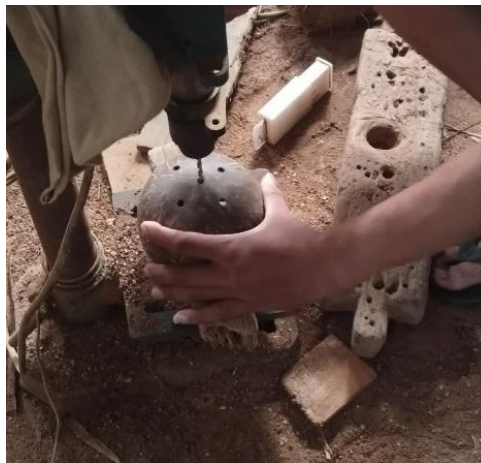
Gambar 2 : Proses pengeboran batok kelapa (Foto : Wijayanto et al. , 2025)
