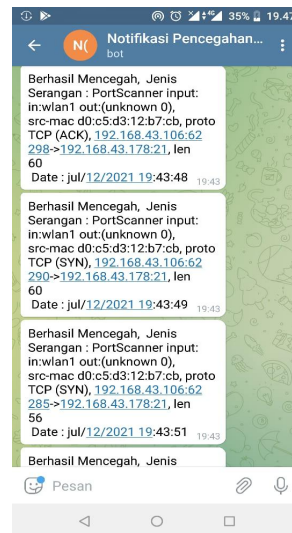
Gambar 3.8 Notifikasi Serangan Port Scanner Telnet pada Telegram
