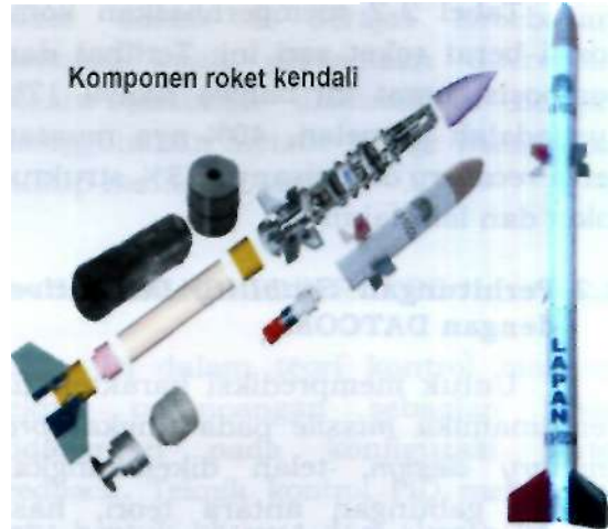
Gambar 2-2: Contoh roket RKX100-C04 dengan breakdown komponen yang digunakan
