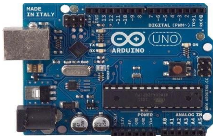
Gambar 3 Arduino Uno Adapun data teknis board Arduino Uno sebagai berikut:
