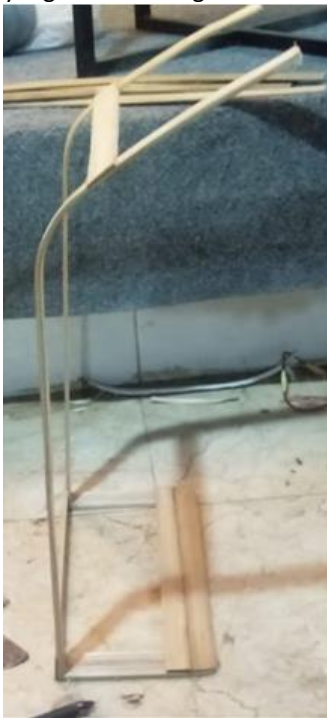
Gambar 9. Perubahan pada konstruksi tas dan tambahan struktur pada bagian samping konstruksi.
