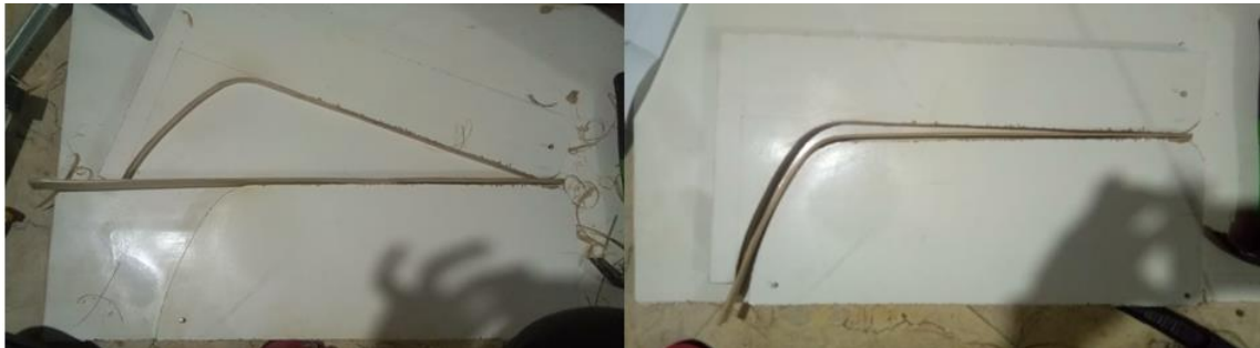
Gambar 7. Proses bending pada bambu
