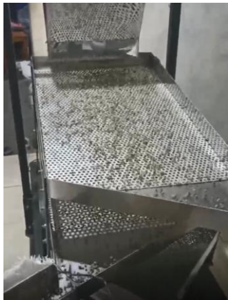
Gambar 2. Hasil rancang bangun mesin sortasi kopi.
