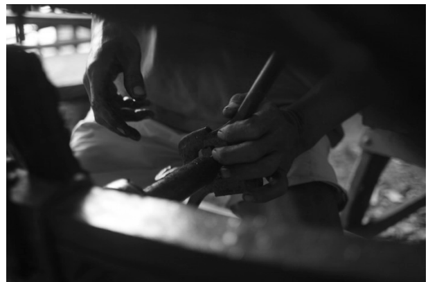
Detail 4. Proses pembuatan ulir pada as roda yang rusak.
