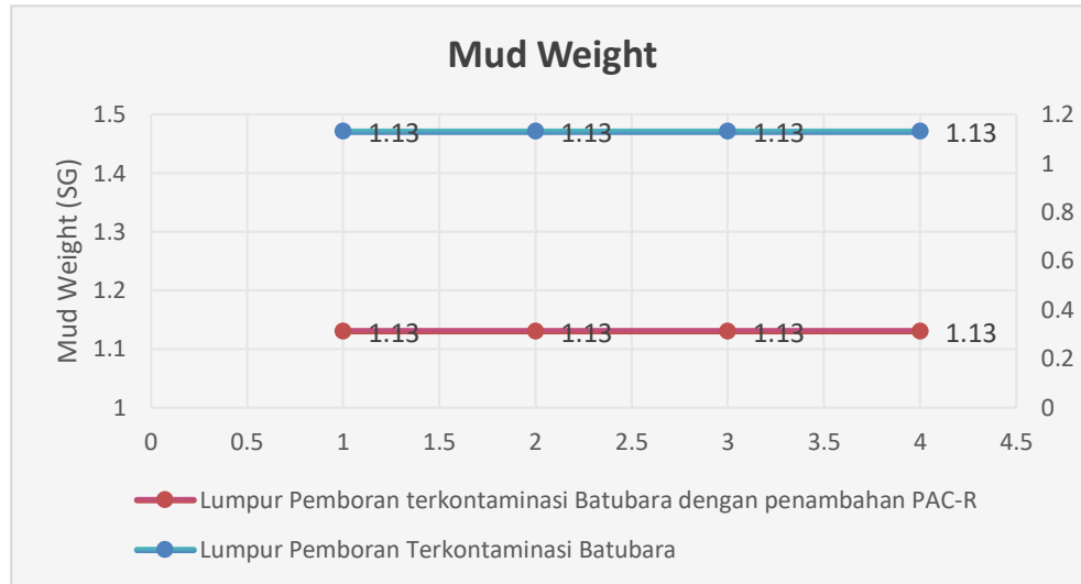
Gambar 2. Hasil Pengujian Mud Weight pada lumpur pemboran
