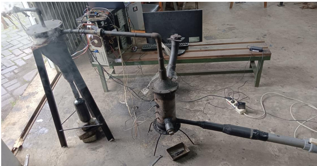
Gambar 1. Setup Penelitian Gasifikasi Updraft
