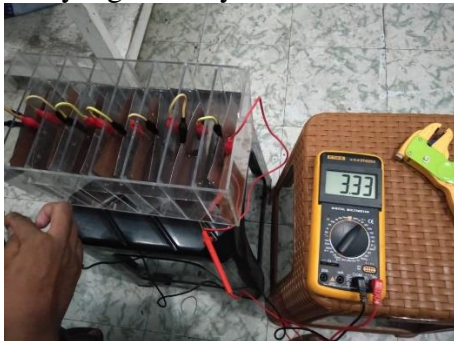
Gambar 5 Hasil pengujian pasang plat tembaga dan aluminium (Cu-Al) tanpa beban
