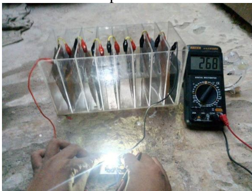
Gambar 8 Hasil pengujian tegangan listrik menggunakan pasang plat tembaga dan plat seng (Cu-Zn) dengan beban.
