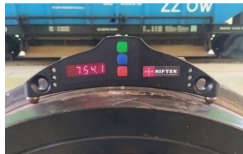
Gambar 9. Pengukuran Roda Dalam Keadaan Benjol Dengan Diameter Wheel Gauge
