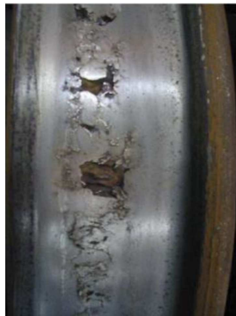
Gambar 3. Roda rusak akibat korosi (Zulkarnain, 2015)
