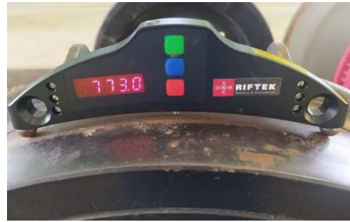
Gambar 8. Pengukuran Roda Dalam Keadaan normal Dengan Diameter Wheel Gauge
