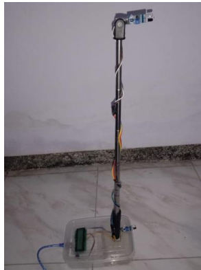
Gambar 1. Tampilan akhir alat praktikum gerak jatuh bebas berbasis arduino nano
