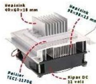
Gambar 4. Thermoelectric Generator Tampak Bawah
