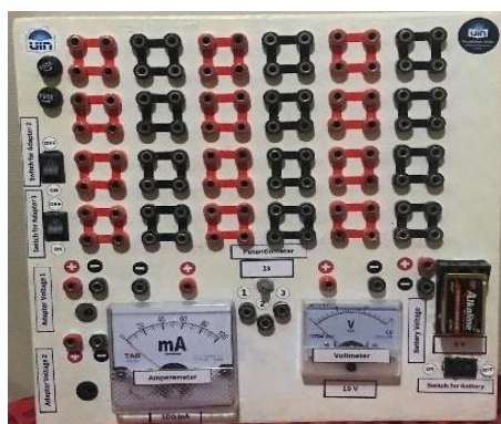
Gambar 6. Alat Peraga Rangkaian Listrik Arus Searah Setelah Disempurnakan
