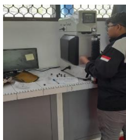
Gambar 4. Proses Pengujian Nilai Kekerasan Dengan Mesin Uji Kekerasan
