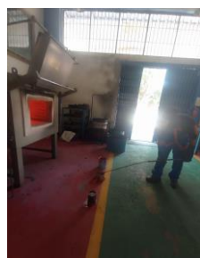
Gambar 3. Proses Pemanasan Dengan Oven Listrik Deskripsi Mesin
