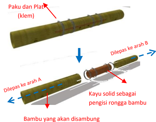
Gambar 21. Detail sambungan memanjang
