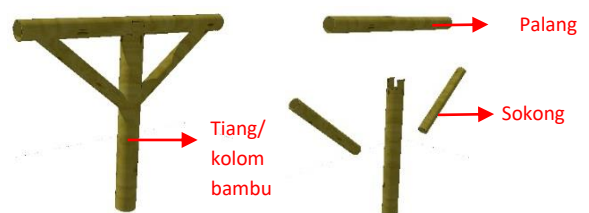
Gambar 25. Detail sambungan tiang dengan palang dan penopang
