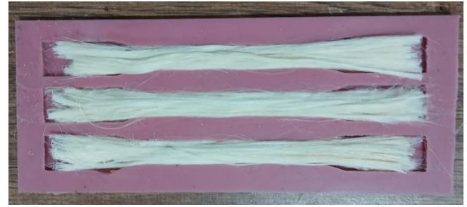
Gambar 4. Proses Pencetakan Spesimen ASTM D638
