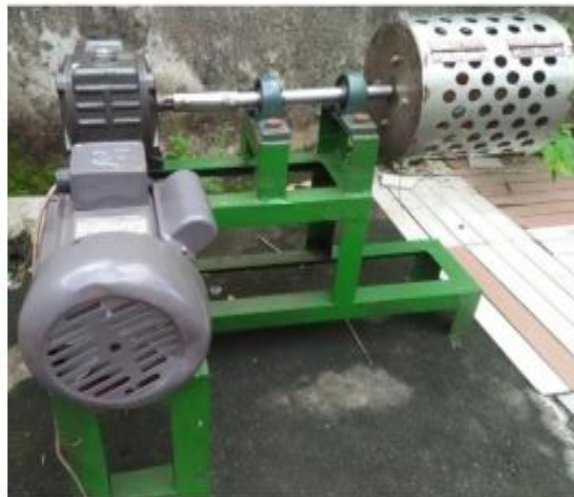
Gambar 2. Mesin Pengupas Bawang Merah[10].
