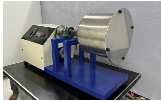
Gambar 1. Mesin Ball Mill Tipe Horizontal (dokumentasi pribadi 2025)
