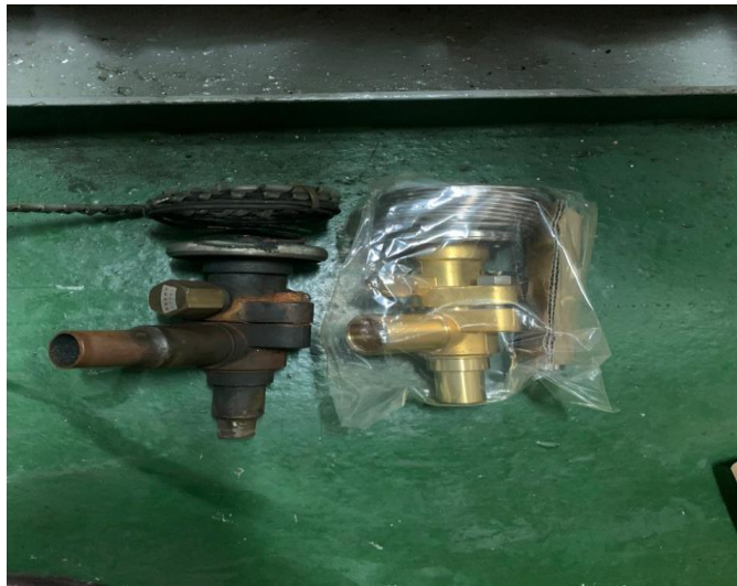
Figure 4. Penggantian expansion valve baru Source : Dokumen pribadi (2023)
