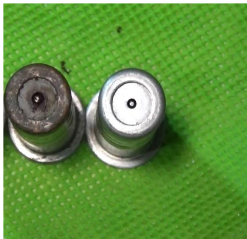
Figure 2. Kondisi orifice rusak Sumber: Dokumen pribadi (2022)
