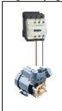
Gambar 17. Wiring NO Kontaktor Ke Beban
